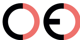
Marcatura CE contraffatta (troppo distante)
